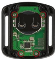
3. 画像に示すように、PCBボードを持ち上げ、バッテリーを取り出します。
