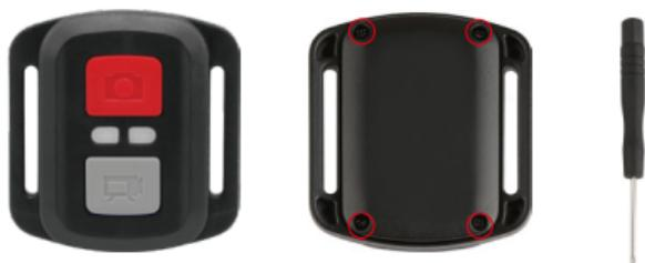
2. PCBボードにある4本のネジを外します。
